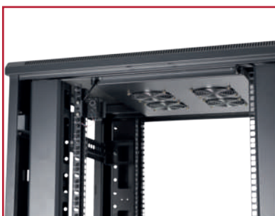
A conjugação das unidades de ventilação e termostrato com a localização estratégica dos rasgos de ventilação, da base ao topo, passando pelas portas e prateleiras, garantem um fluxo eficiente de ar, gerando as melhores condições de operacionalidade dos equipamento alojados (nº ventiladores depende do modelo - ver tabela "Dimensões e acessórios incluídos").
